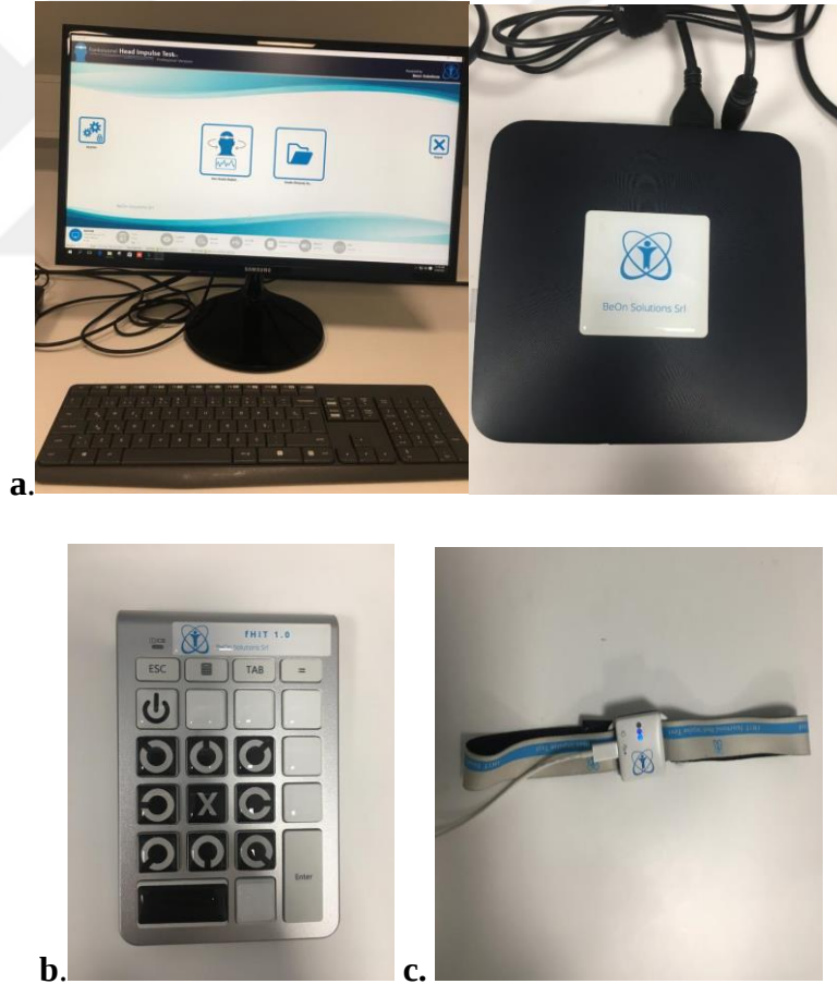
Şekil 5.3.6.1. a. Test yazılımını içeren (hasta kaydı, statik ve dinamik görme keskinliğinin lateral ve vertikal kanallarda gerçekleşmesini sağlar.) monitör. b. Statik ve dinamik görme keskinliğinin değerlendirilmesinde kullanılan Landolt C optotipinin yönünün seçmesini sağlayan mini klavye. c. Başın açısal hızını ve yönünü ölçmek için kullanılan jiroskop.
